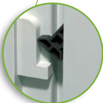
Ειδικός μηχανισμός ανύψωσης πόρτας για τα μεγάλα ερμάρια (ARIA 75 και μεγαλύτερα) εξασφαλίζοντας την κεντρική θέση της πόρτας κατά το κλείσιμο
